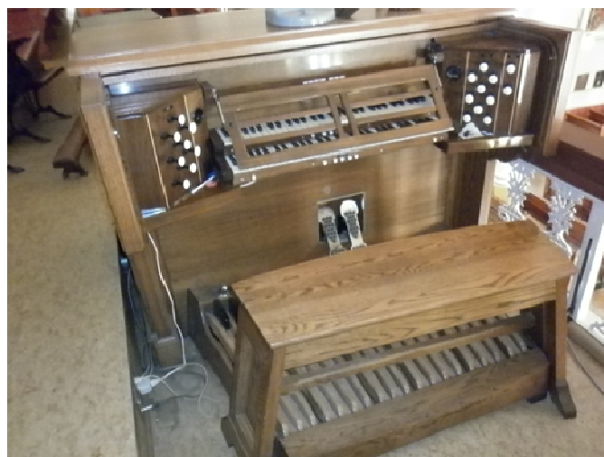
La Console de l'orgue actuel de l'église de Neuville, lequel orgue fut converti d'un orgue à soufflet à un orgue électro-pneumatique.
